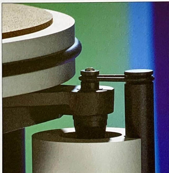
Eine clevere Lösung: O-Ringe stabilisieren die Federung des Avid und verhindern damit das sich Aufschaukeln und Taumeln des entkoppelten Subchassis.
